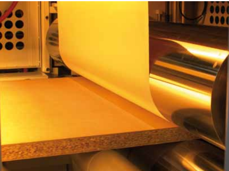
Detalle de laminación Detail of lamination
