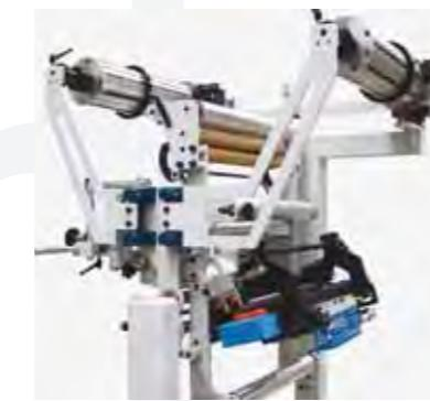
Cabezal independiente con doble desbobinador.
