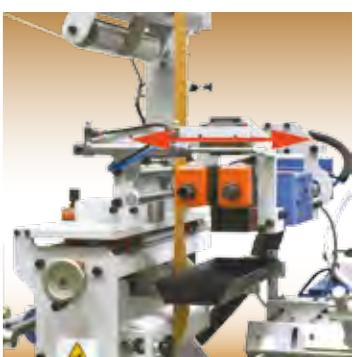
Guías de entrada de moldura de ajuste rápido.
