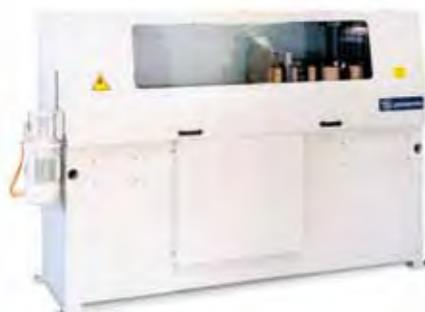
Sierra para cortar molduras y perfiles en posición vertical (laterales de cajón, etc.).
