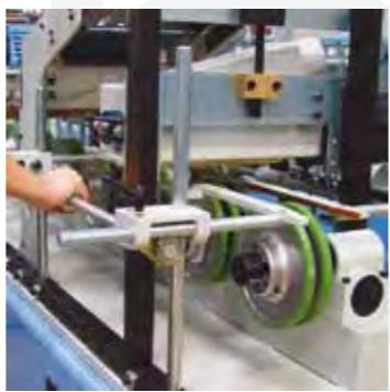
Cabezal aplicador de cola PUR sistema labio.
