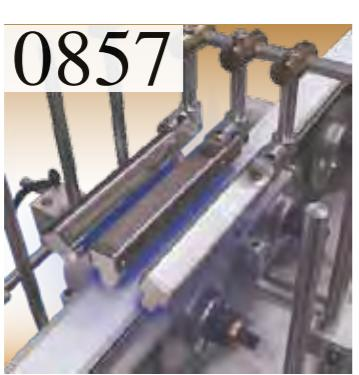
Sistema de cambio rápido para el rodillo prensor del cabezal de cola termofusible.
