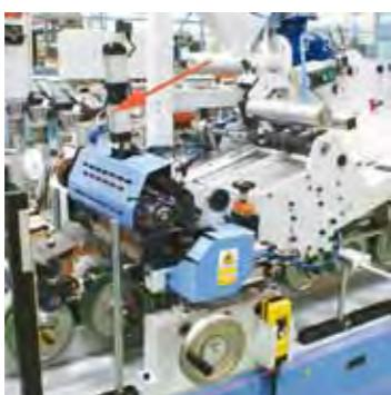
Elevación cabezal aplicador cola termofusible.
