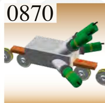
Desplazamiento manual del cabezal termofusible para el cambio del centro de recubrimiento.
