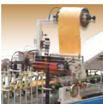
Cabezal aplicador de cola termofusible sistema rodillo.
