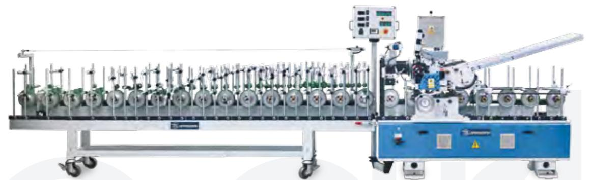
Máquina con bancada dividida en dos partes de las cuales la unidad base es fija y la unidad de laminación es desplazable. Mientras una unidad de laminación está en producción se puede estar preparando otra unidad de laminación para otro perfil.
