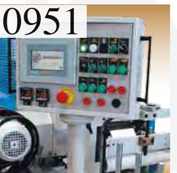
Sistema de ajuste centralizado de la velocidad electrónica de varias máquinas.
