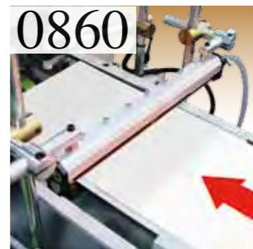
Elevación cabezal aplicador cola termofusible.
