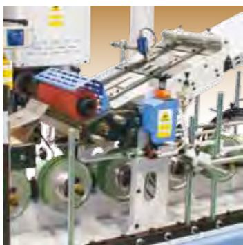
Cabezal aplicador de cola termofusible sistema rodillo.
